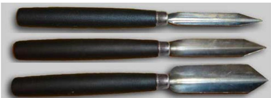
Рис. 3.2. Карбовочные ножи с треугольным сечением (малый, средний, большой)
