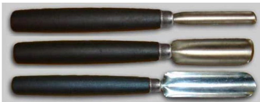
Рис. 3.3. Карбовочные ножи с овальным сечением (малый, средний, большой)
